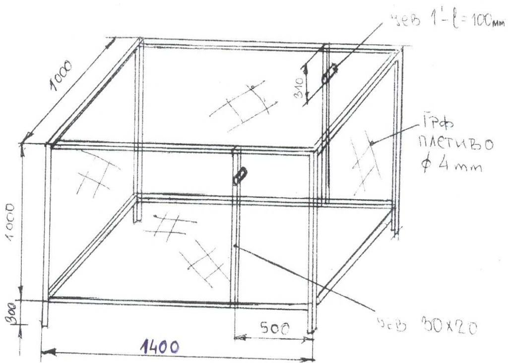
Остала конструкција је од L 25x25 топло ваљаних,са поклопцем од истог материјала,обезбеђен са два отвора  $\phi$  150 за убаcивање флаша,и са две ручице за отвраraњe,са испуном од гриф плетива  $\phi$  4mm са окцима 50x50.
